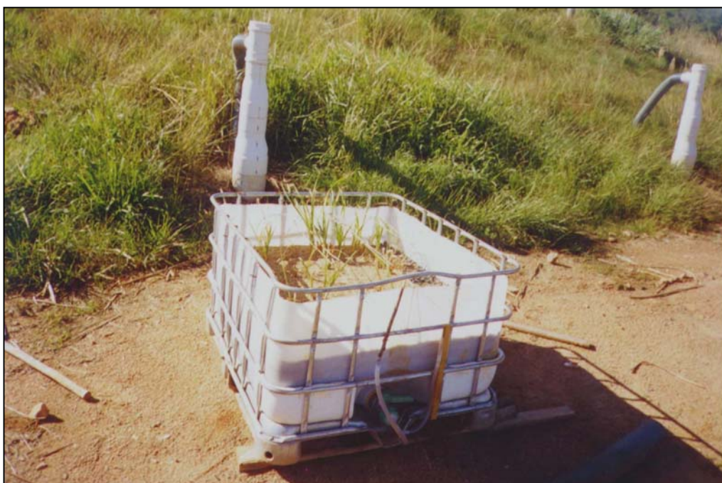
Figura F.2 - Registro fotográfico do banhado-piloto no dia 14 do ciclo de operação sem cobertura
