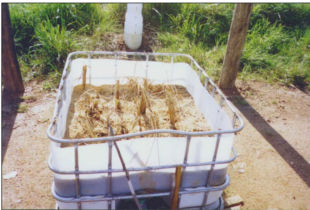
Figura F.8 – Registro do banhado-piloto no dia 28 do primeiro ciclo de operação com cobertura
