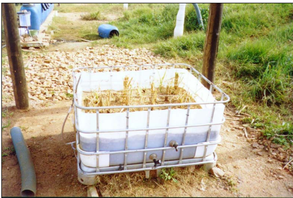
Figura F.6 – Registro fotográfico do banhado-piloto no dia 14 do primeiro ciclo de operação com cobertura
