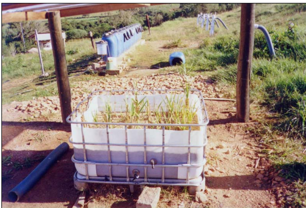
Figura F.4 – Registro fotográfico do banhado-piloto no dia 0 (zero) do primeiro ciclo de operação com cobertura
