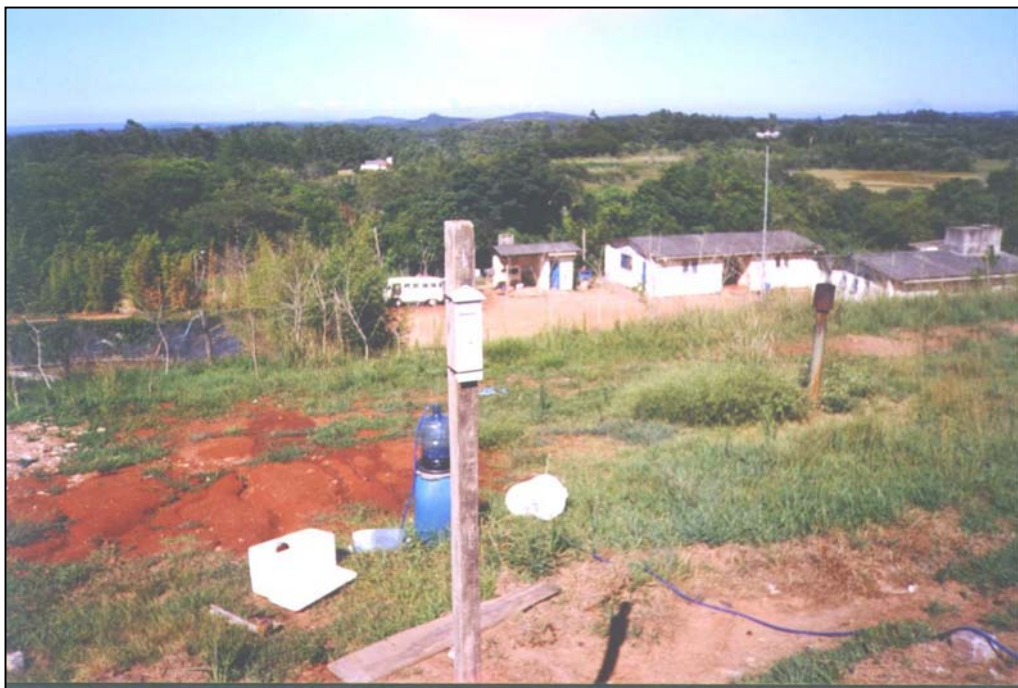
Figura F.23 – Termômetro de mínima e máxima instalado na área do experimento
