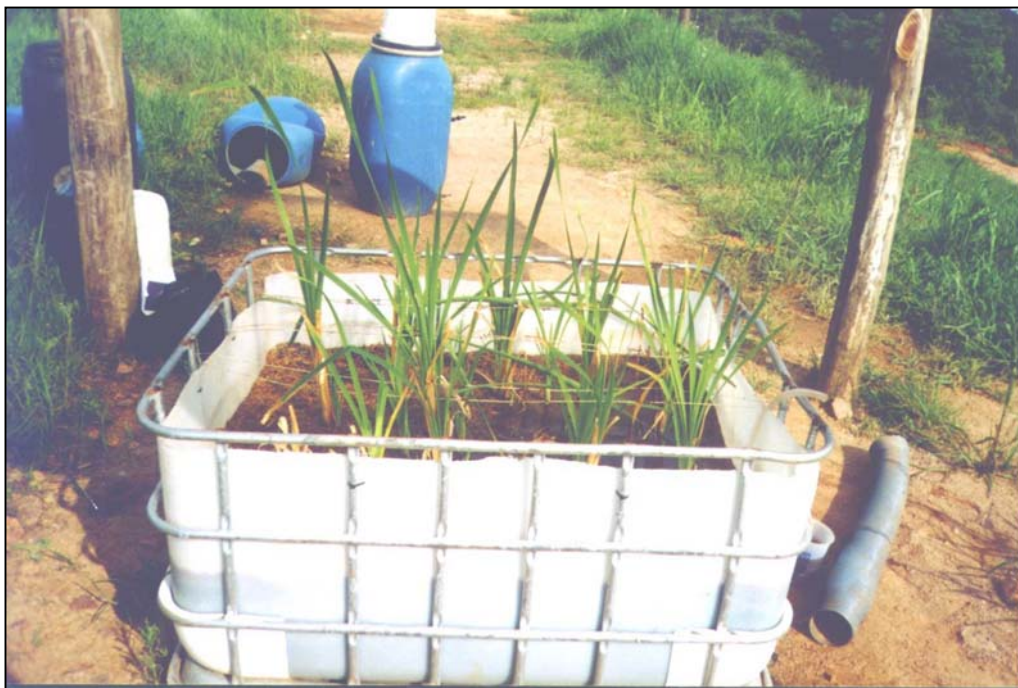
Figura F.15 – Registro fotográfico do banhado-piloto no dia 21 do quarto ciclo de operação com cobertura
