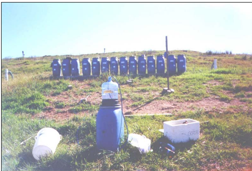
Figura F.25 – Coleta de efluente de um dos reatores anaeróbios da Subfase A.1
